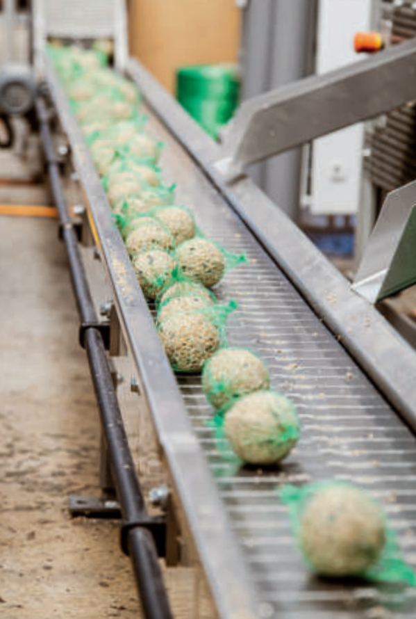
Frisch aus der Kühlkammer rollen die Meisenknödel vom Band und werden direkt verpackt.
